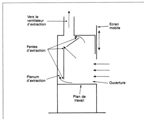
Fig. 1. Schéma général d'une sorbonne
